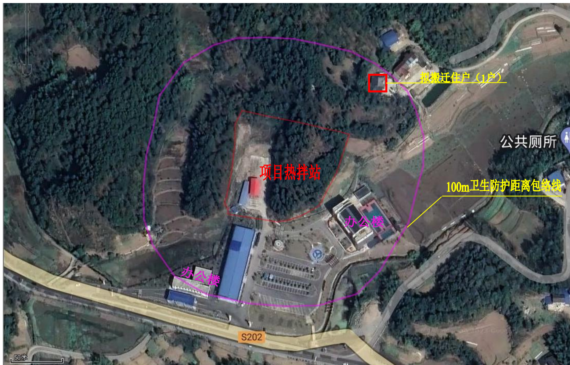
附图 7：项目热拌站卫生防护距离包络线图
