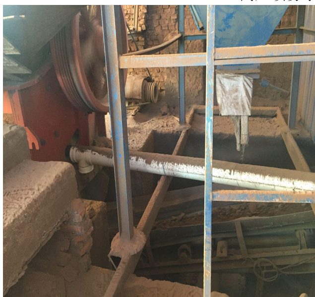
整改前：鄂破机出料口集尘罩设置不规范
