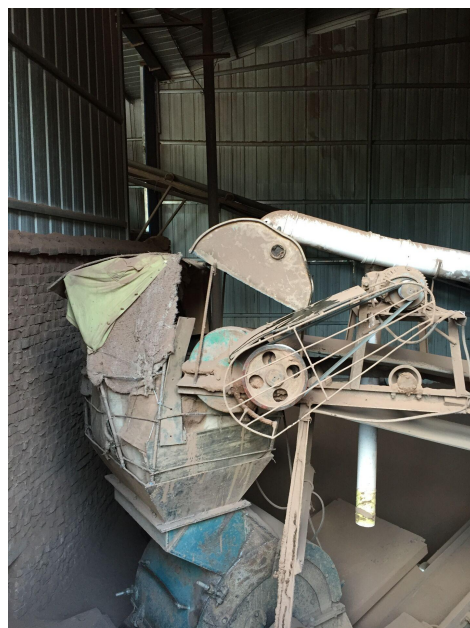
整改前：粉碎机进料口集尘罩设置不规范 整改后：粉碎机进料口集尘罩 (2) 硬化页岩堆场路面，修建车辆冲洗平台，减少原料运输产生的扬尘。
