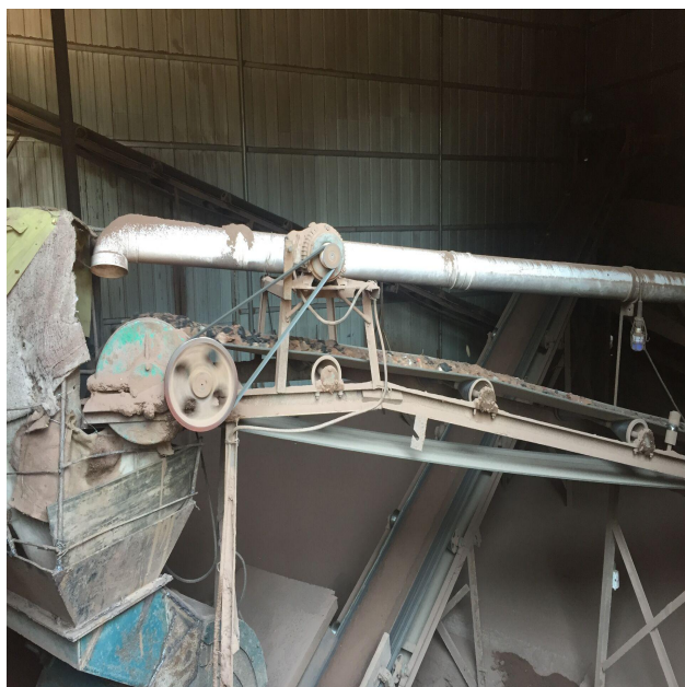
整改前：粉碎机进料口集尘罩设置不规范 整改后：粉碎机进料口集尘罩 (2) 硬化页岩堆场路面，修建车辆冲洗平台，减少原料运输产生的扬尘。
