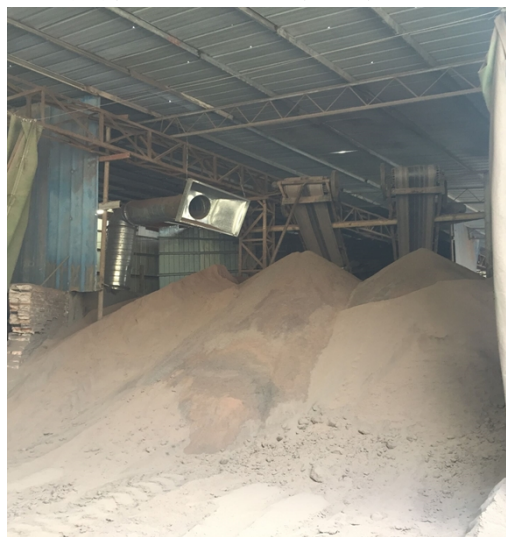
整改后：输送机末端处集尘罩
